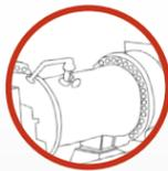
**2** La "K" invertida sufrió un desplazamiento de 4 cm que la arrastró sobre el suelo. El movimiento fue superior al esperado (3,000 toneladas), por lo cual se determinó frenar la operación y retirar la pieza.
