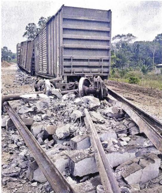
El paso de un tren destruyó los nuevos durmientes que son colocados en la vía del Istmo de Tehuantepec.
