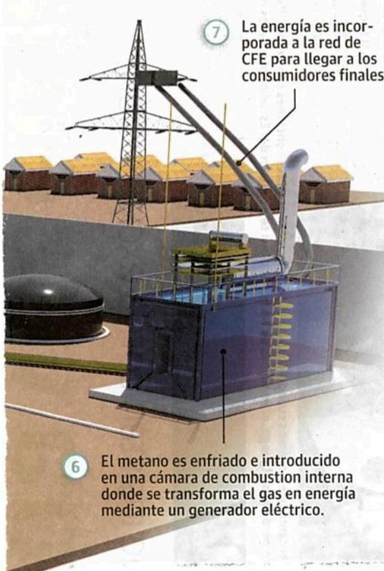
6 El metano es enfriado e introducido en una cámara de combustión interna donde se transforma el gas en energía mediante un generador eléctrico.
