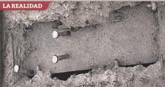
Fallas estructurales, falta de pernos (foto) y mala soldadura provocaron el accidente en Línea 12, según dictamen preliminar.
