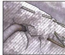
**05** La distancia entre el acero de refuerzo y la superficie superior de la losa no refleja las dimensiones requeridas de recubrimiento.
