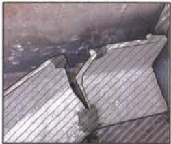
**02** Se registran fracturas en las travesías con desprendimiento de material de los refuerzos.
